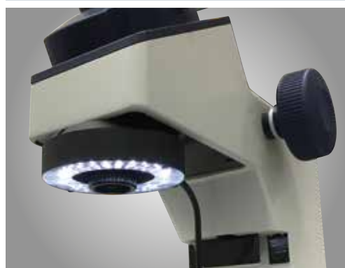
LED пръстеновиден светлинен източник или приложения, изискващи цялостно осветление.
